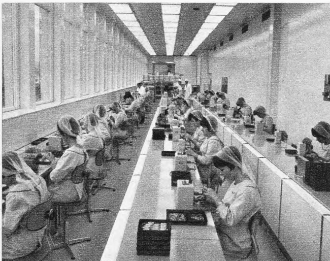
Bild 1. Vollklimatisierter Montageaum für die Bildröhrenfertigung (Werkaufnahme: SEL)
