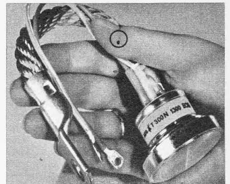
Der derzeit größte Silizium-Thyristor von AEG-Telefunken schaltet Leistungen von mehr als 1000 kW. Im Kreis der gegenwärtig kleinste Transistor der gleichen Firma
